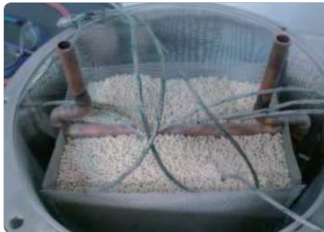
Obr. 5 Tepelný akumulátor na báze Zeolitu
